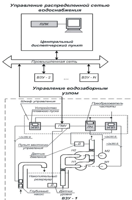
Рисунок 1.4.2.1 - Общая примерная функциональная схема автоматизации ВЗС
