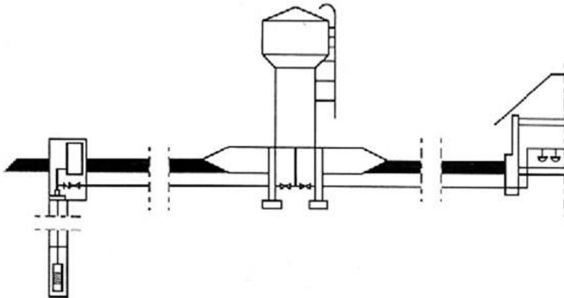
Рисунок 1.1.4.1.1. Схема водоснабжения населенного пункта при заборе воды из подземного источника
