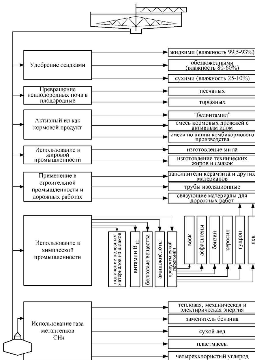
Рисунок 2.5.2.1 - Схема утилизации осадков сточных вод
