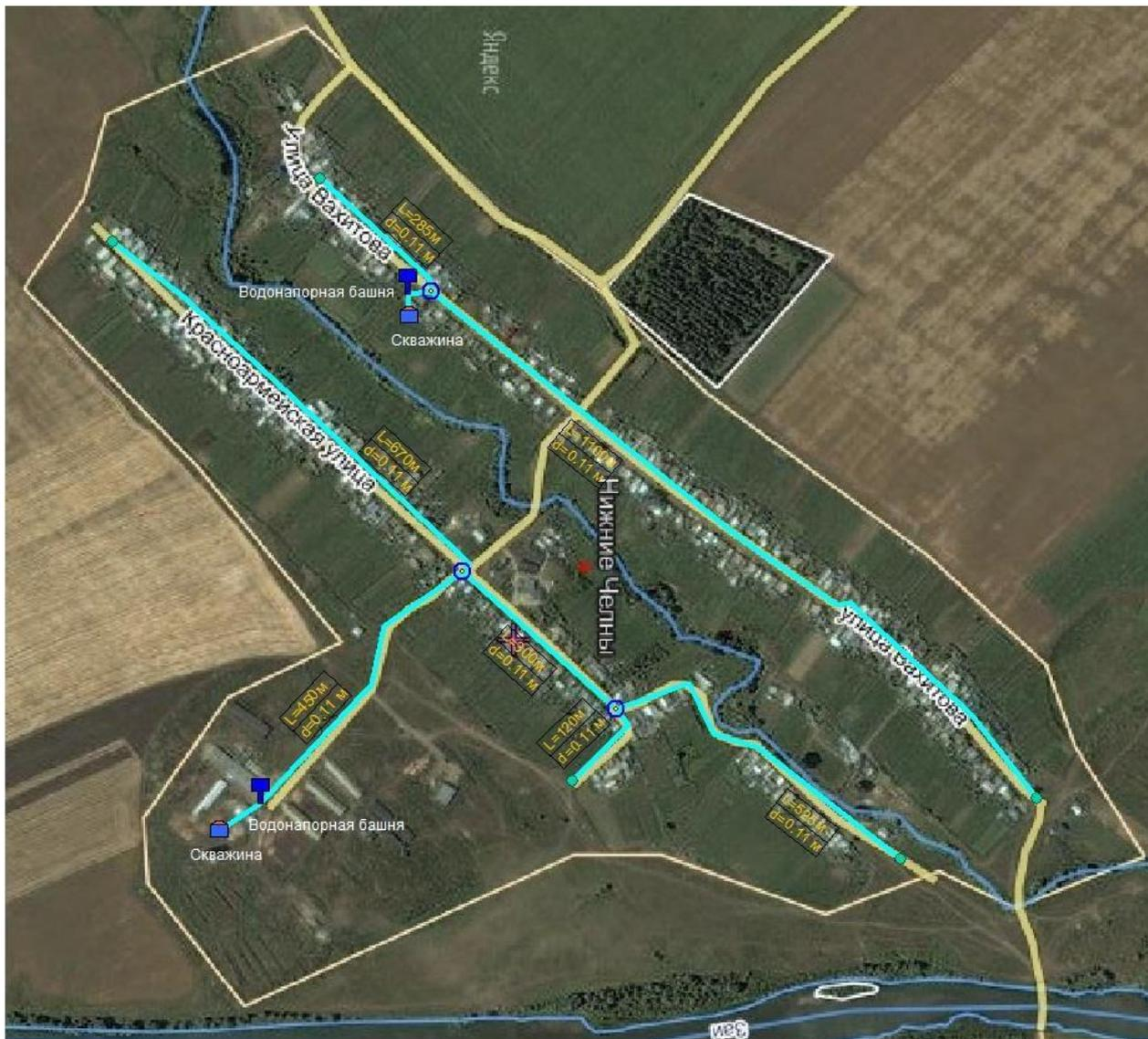
Рисунок 1.1.3.2 Зона централизованного водоснабжения н.п. Нижние Челны
